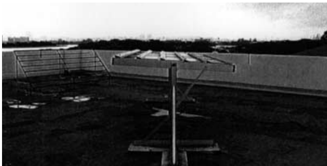
写真1 シンガポール暴露試験の状況
