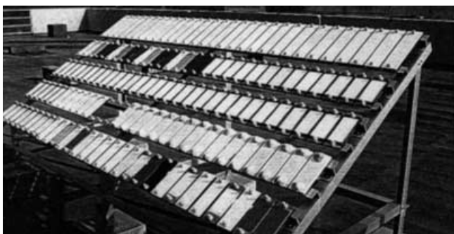
写真2 沖縄暴露試験の状況
