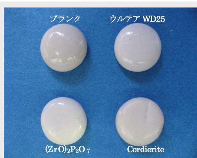
図6 各種低熱膨張性フィラー配合ガラスの流動性
