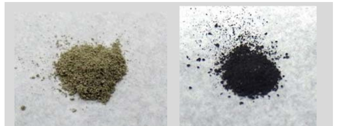
図 10 1,800°C 処理生成物の外観 (左: VH-SQ, 右: St-H-SQ)
