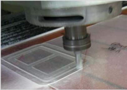
図6 NCルーターによる X-157 の加工
