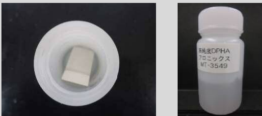
写真2 金属腐食性評価の様子
