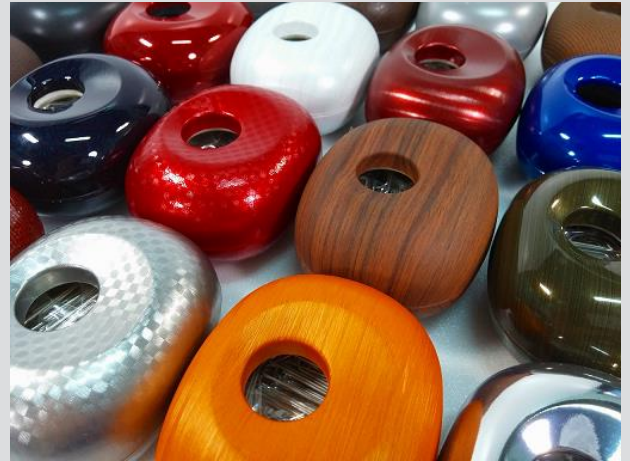
図1 真空圧空成形によるフィルム加飾の例 6)
