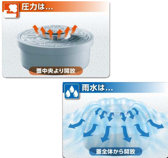
図10 塩ビ製ふたによるオーバーフロー
