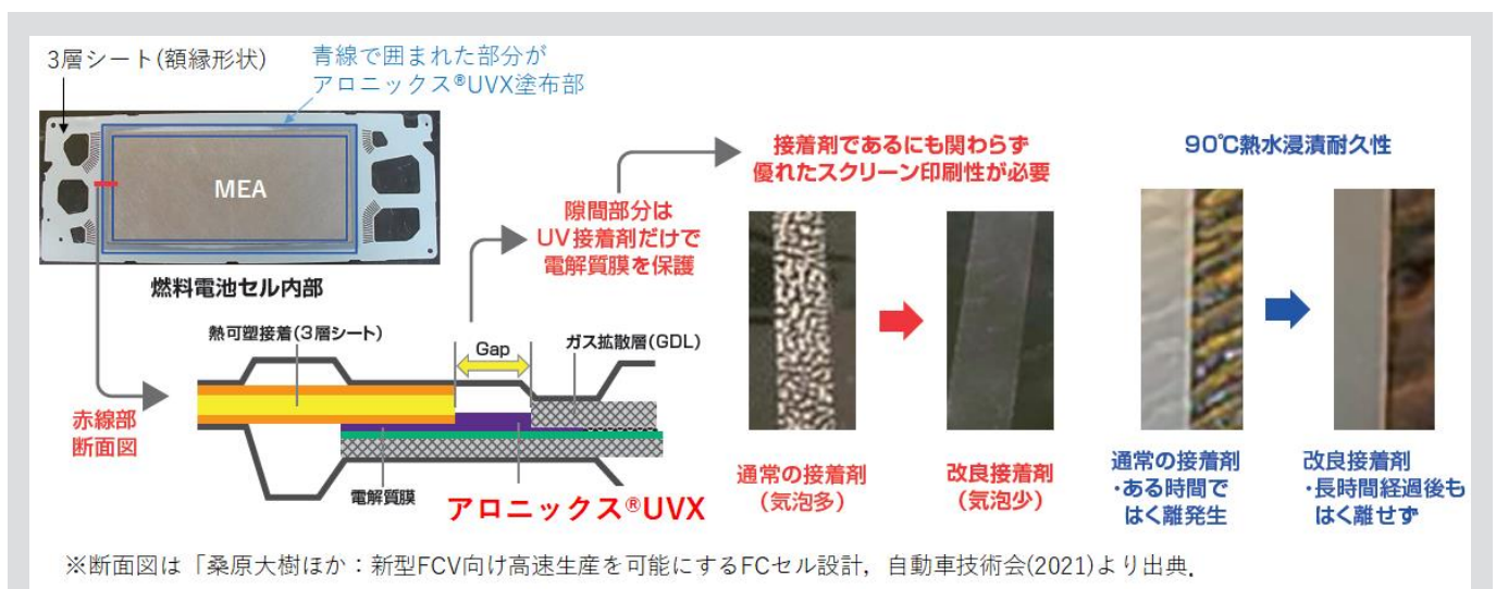
図2 光硬化型接着剤アロニックス®UVX の使用部位と特長
