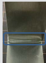
図2 補強するときの接着例 青枠部分が、接着剤を追加で塗布、硬化した箇所
