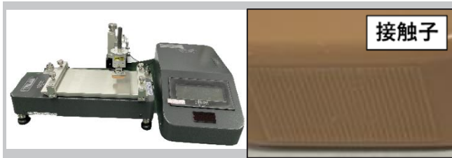
写真1 多機能型摩擦測定機と指紋形状の接触子
