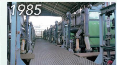
1985 名古屋工場電解設備をイオン交換膜法に転換
