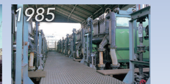
名古屋工場電解設備をイオン交換膜法に転換
