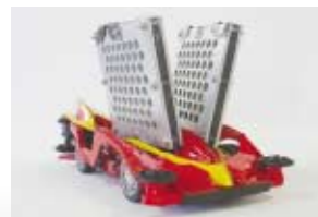
細孔フィリング電解質膜を用いた燃料電池を搭載したミニカー
