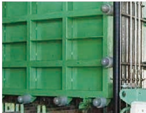
ガス拡散電極電解槽
