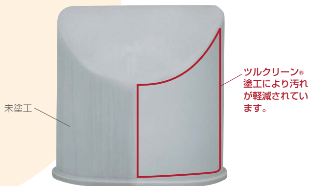
●現場施工した排気口(3カ月経過時)
