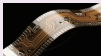
FPC (フレキシブルプリント基盤) 用の接着剤 ※銅箔とPETフィルム等の接着
