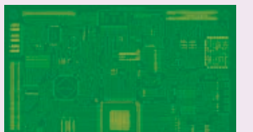
ソルダーレジスト ※電子基板へのハンダ付着防止
