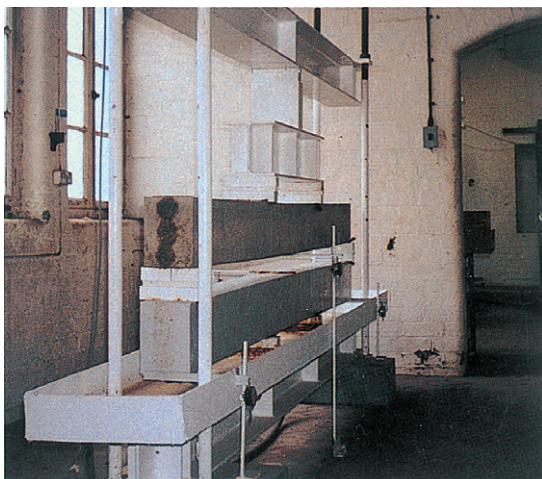
持続荷重試験状況
