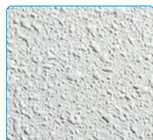
ST工法 (スター状仕上げ)
